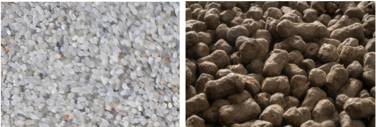
Figuur 5. Omstortingsmaterialen: omstortingsgrind (links) en zwelklei (rechts).
