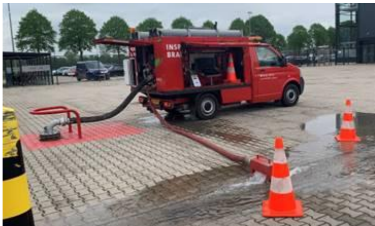
Figuur 1. Uitvoering van een pomptest door de brandweer.
